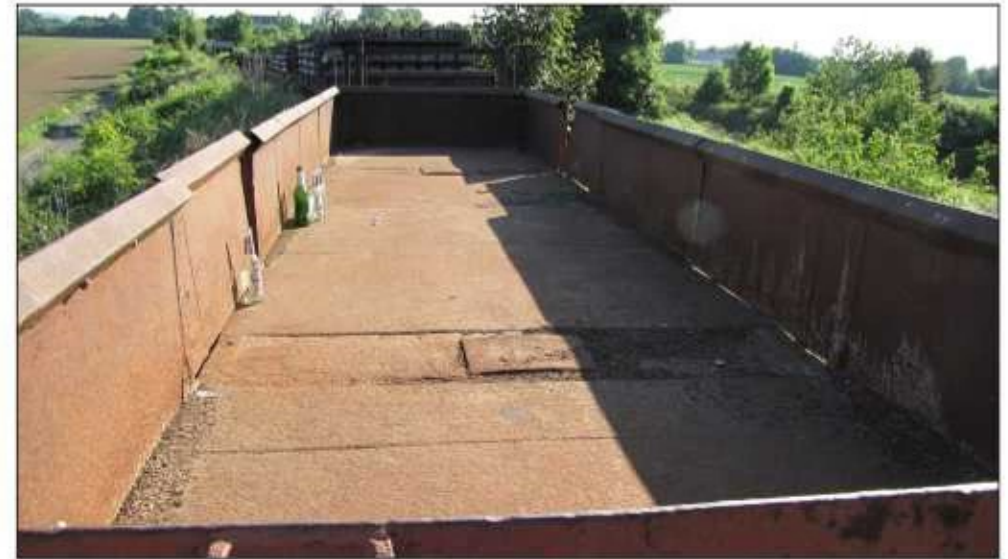
Ein Blick auf die Ladefläche von Wagen 0344 lässt auch die klappbaren Seitenteile erkennen. Foto: Robert Nöther
