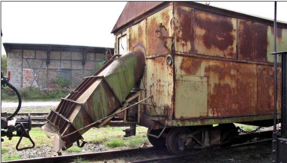
Die Trichterkupplung an der Vorderseite ermöglicht es, die Schneeräumdüse mittels Kuppelstangen auch von dieser Seite aus bewegen zu können. Foto: Robert Nöther
